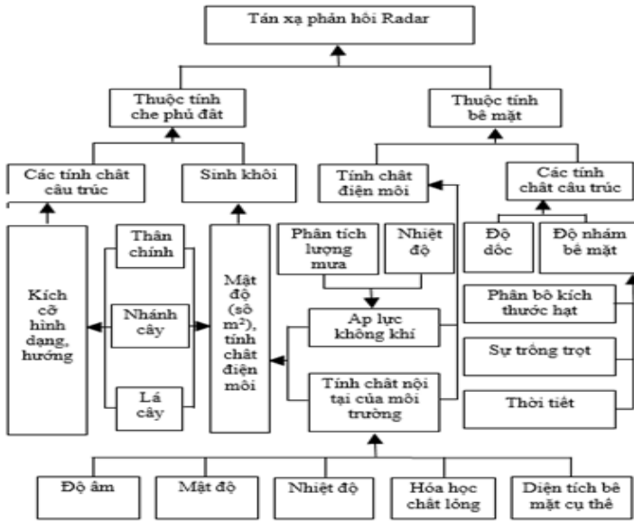
Hình 2-8: Các yếu tố chính ảnh hưởng đến tán xạ ngược từ địa hình.
